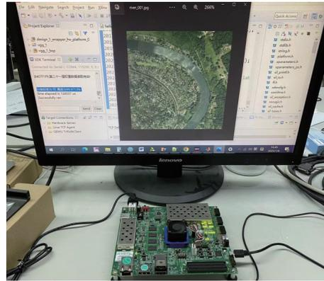
图 12 ZCU104 硬件平台测试图
